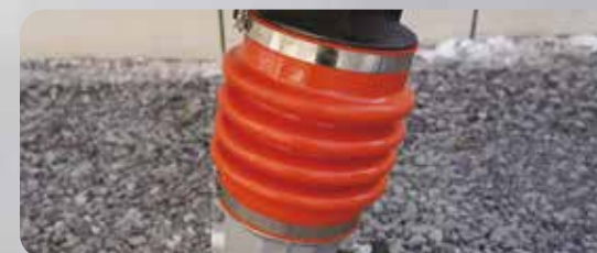
Amortiguador engrosado de poliuretano, durable y anti-deformación
